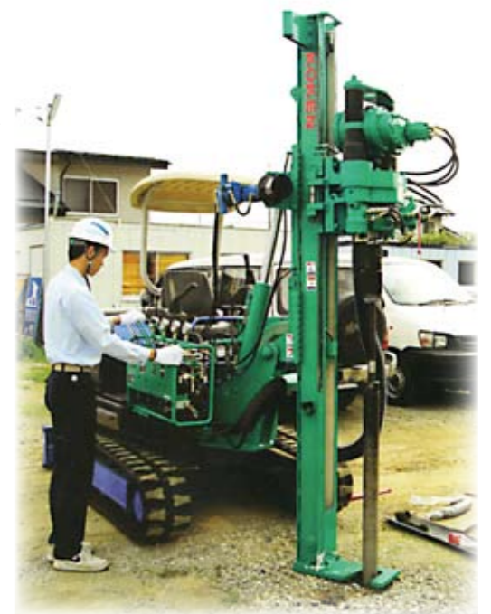
土壌汚染状況・詳細調査用ボーリングマシン （調査協力：(株)土木管理総合試験所）
